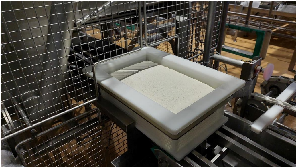
Fot. 6. Uformowany i wstępnie wyprasowany ser opuszczający urządzenie kolumnowe
